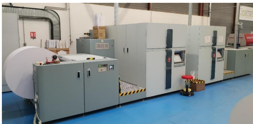
Presse jet d'encre Canon intégrée à une chaîne de finition Tecna 100% automatisée
